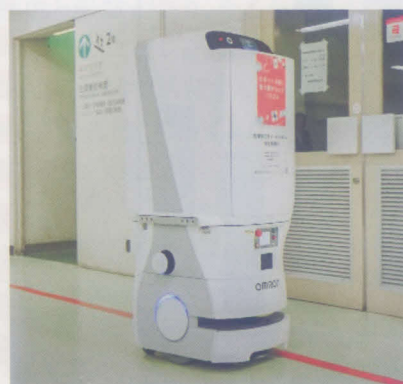
医療現場で実証実験中の薬剤搬送用ロボット
