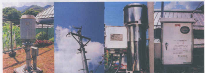
▲(左から)雨量計/風向風速計、日照計/電気式温度計/データ変換装置
